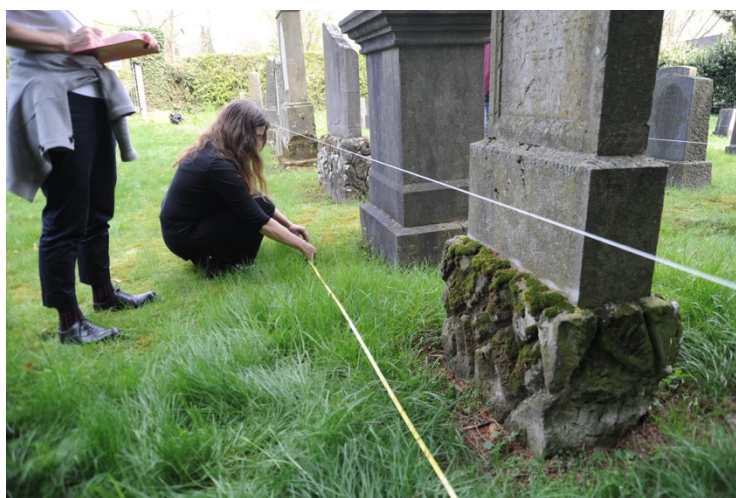
Abb. 2: Vermessung des Friedhofs in Krefeld-Hüls mit einfachsten Mitteln hier: Schnüre zum Einmessen der Grabreihen
