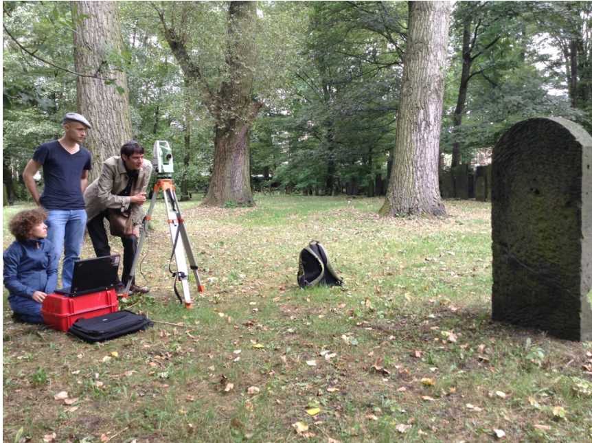
Abb. 3: Vermessung des sog. Hamburger Teils des Jüd. Friedhofs Hamburg-Altona mit Totalstation und CAD-Plugin.
